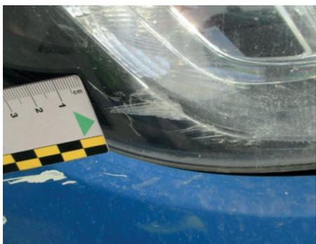
PROIETTORE: Lievi graffi, abrasioni o scheggiature superiori a 10 cm e/o superiori a 3 unità per elemento (nei casi ove tecnicamente possibile, sarà valutata la riparazione a vantaggio della sostituzione).
