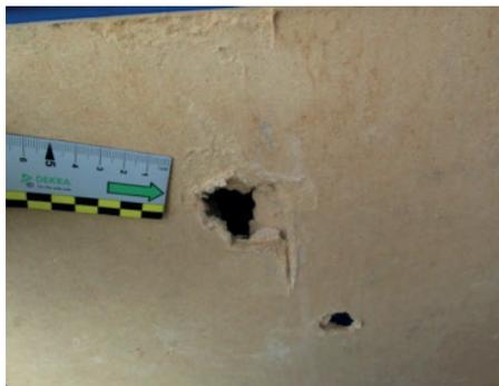
Fori, strappi, lacerazioni, gravi deformazioni del pavimento di carico o dei relativi rivestimenti.
