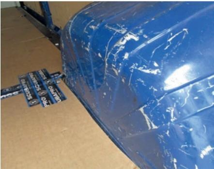
▶ Graffi e/o abrasioni senza principio di corrosione.
