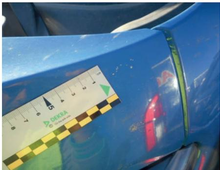
Scheggiature di dimensioni maggiori a 3 mm e superiori al 30% dell'area dell'elemento. Qualsiasi scheggiatura che abbia intaccato il film di vernice, con principio di corrosione.
