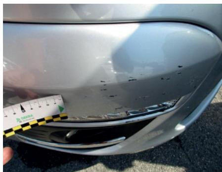
ELEMENTI DI MATERIALE PLASTICO VERNICIATO: Scalfitura/Abrasione di dimensione massima complessiva superiore a 5 cm in numero superiore alle 3 unità per elemento. Tutti i graffi o attriti, di qualsiasi lunghezza, con asportazione di materiale; qualsiasi deformazione e/o incisione.
