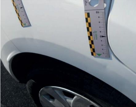
▶ Massimo n. 5 bolli di dimensioni inferiori a 10 mm senza sbacco del film di vernice.
