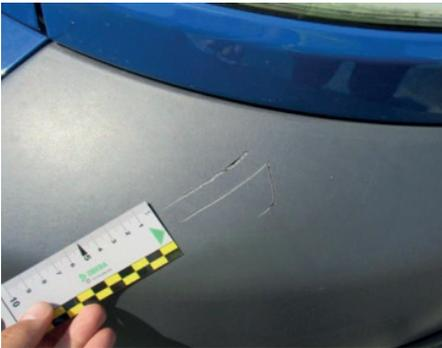
ELEMENTI DI MATERIALE PLASTICO NON VERNICIATO: Abrasione/Riga di estensione inferiore a 10 cm e/o di numero massimo alle 3 unità per elemento. Nessuna deformazione e/o incisione.
