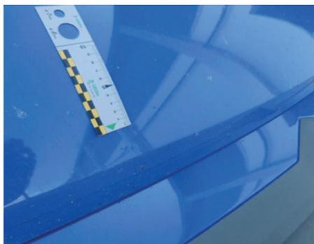
Scheggiature di dimensioni inferiori a 3 mm e inferiori al 30% dell'area dell'elemento. Nessun danneggiamento al film di vernice e/o principio di corrosione.
