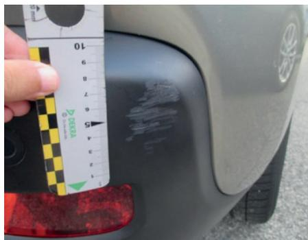
ELEMENTI DI MATERIALE PLASTICO NON VERNICIATO: Abrasione/Riga di estensione massima superiore a 5 cm e/o di numero superiore alle 3 unità per elemento. Qualsiasi deformazione e/o incisione.
