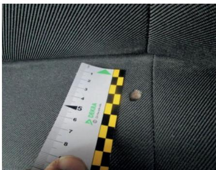
Bruciatura con diametro > 10 mm. Sarà prevista sempre la sostituzione dell'elemento.
