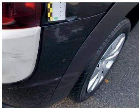
ELEMENTI DI MATERIALE PLASTICO VERNICIATO: Scalfitura/Abrasione di dimensione massime complessive superiori a 10 cm senza intacco del film di vernice e/o in numero superiore alle 3 unità per elemento. Tutti i graffi o attriti, di qualsiasi lunghezza, con asportazione di materiale; qualsiasi deformazione e/o incisione.
