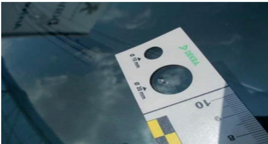
Scheggiatura sul parabrezza di dimensioni: inferiore o uguale ad 1 cm fuori dal campo visivo (qualora sia tecnicamente fattibile, sarà prevista la riparazione dell'elemento a vantaggio della sostituzione, con costo forfettario).
