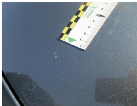
Scheggiature di dimensioni maggiori a 3 mm e superiori a 10 unità per elemento. Qualsiasi scheggiatura che abbia intaccato il film di vernice.
