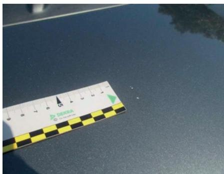
Scheggiature di dimensioni minori a 3 mm ed inferiori a n.10 unità per elemento, il film di vernice non dovrà essere intaccato.
