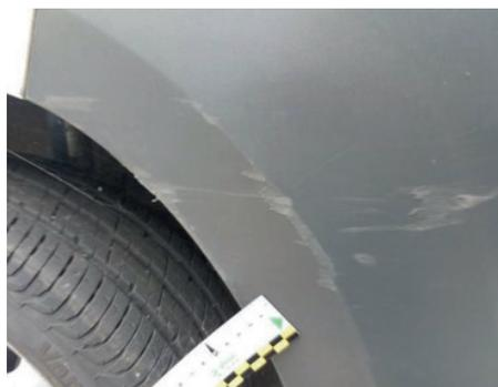
ELEMENTI DI MATERIALE PLASTICO NON VERNICIATO: Abrasione/Riga di estensione massima superiore a 10 cm e/o di numero superiore alle 3 unità per elemento. Qualsiasi deformazione e/o incisione.
