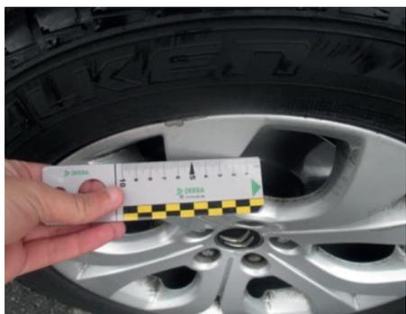
Distacchi di materiale (qualora non sia pregiudicata la sicurezza, sarà valutata la riparazione a vantaggio della sostituzione).
