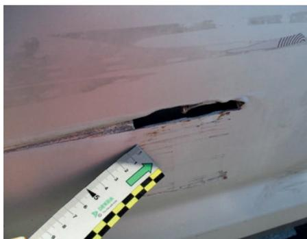
Non accettate ammaccature e/o rientranze che compromettono la funzionalità/sicurezza dell'elemento.
