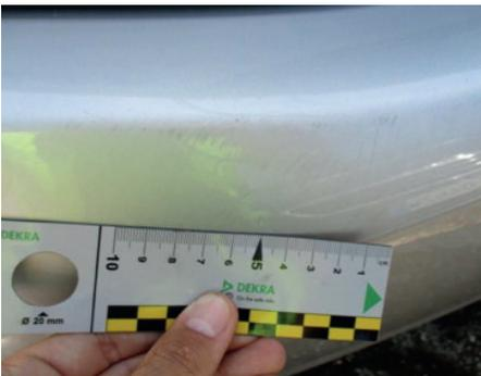
ELEMENTI DI MATERIALE PLASTICO/ VERNICIATO: Scalfittura/Abrasione di dimensione inferiore a 10 cm senza intacco del film di vernice e/o in numero massimo alle 3 unità per elemento. Nessuna presenza di asportazione di materiale e/o di deformazioni e/o incisioni.
